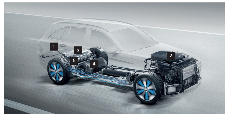
Disposición del sistema de pila de combustible en el ejemplo del GLC F-CELL
