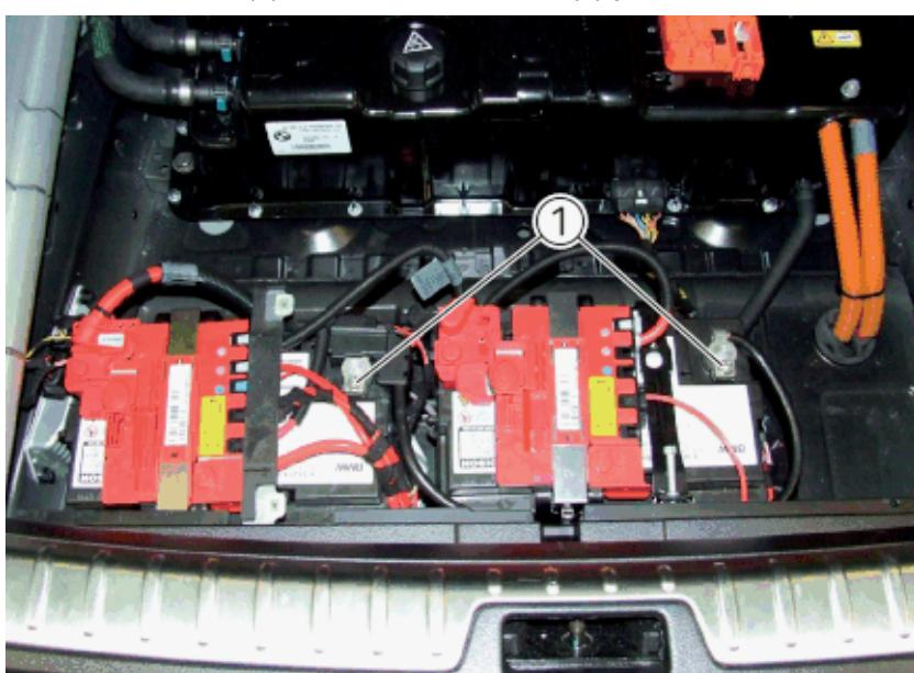
Aflojar las tuercas (1) y extraer hacia arriba los cables negativos de las baterías.
