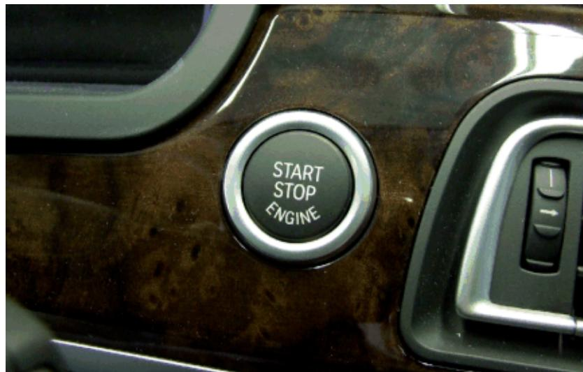
Con el motor en marcha o visualizaciones activas en el tablero de instrumentos, pulsar la tecla "START STOP ENGINE" para desconectar el encendido.
