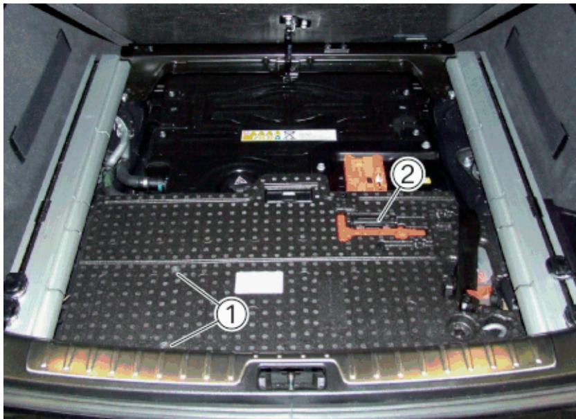
Soltar los tornillos (1) con un destornillador (2) y extraer la cubierta.
