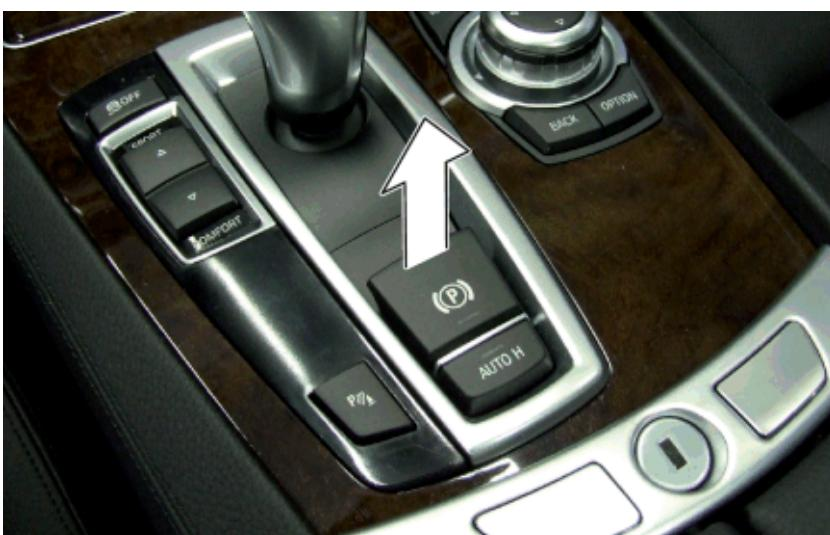
Tirar hacia arriba del conmutador del freno de estacionamiento eléctrico.
