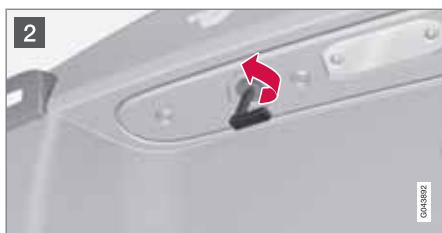
El maletero puede abrirse manualmente con la llave extraíble si se descarga la batería del automóvil. En ese caso, el maletero no puede abrirse con el botón del panel de las luces.
