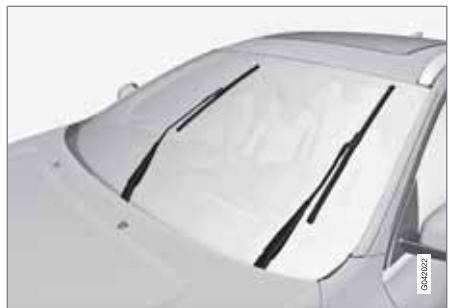
Para poder cambiar, lavar o levantar las escobillas (para extraer el hielo del parabrisas), éstas deben estar en posición de servicio.
