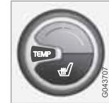
La temperatura puede ajustarse con el mando. En sistemas ECC\*, la temperatura puede ajustarse de manera independiente en el lado del conductor y el lado del acompañante.
