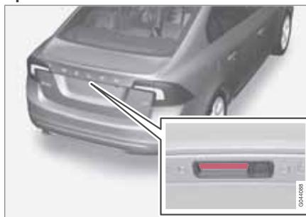
El maletero se mantiene cerrado por una cerradura eléctrica. Para abrir:
