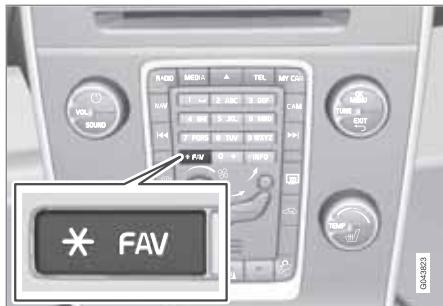
El botón **FAV** se utiliza para almacenar funciones que se emplean con frecuencia, lo que permite iniciar fácilmente la función pulsando **FAV**. Seleccione un favorito (por ejemplo **Ecualizador**) para cada función de la siguiente manera:
