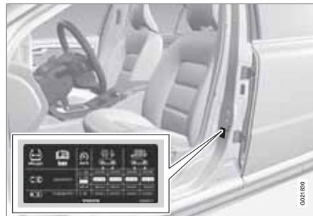
La placa de presión de neumáticos situada en el montante de la puerta del lado del conductor (entre la puerta delantera y la trasera) especifica la presión que deben tener los neumáticos en diferentes condiciones de carga y velocidad. Esos datos se indican asimismo en la tabla de presiones de neumáticos, ver la página 353.
