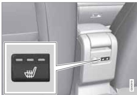
Con una pulsación del botón, se obtiene el máximo nivel de calefacción – se encienden tres luces.
