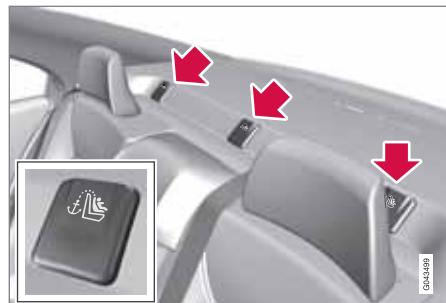
El automóvil está equipado con puntos de fijación superiores para asientos infantiles. Estos puntos de fijación están situados en la bandeja trasera y se ocultan con tapas de plástico. Aparte las tapas de plástico para acceder al punto de fijación respectivo.
