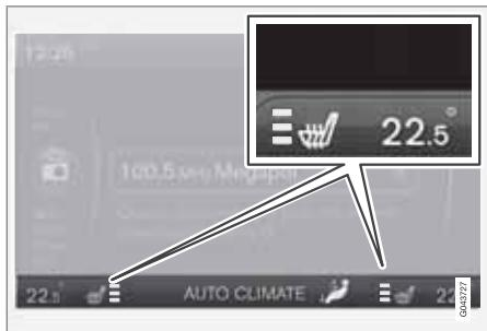
El nivel de calefacción se indica en la pantalla de la consola central.
