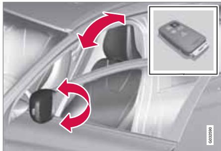
Cuando se abre el vehículo con la misma llave con la que se cerró y se abre la puerta del conductor, el asiento del conductor y los retrovisores exteriores adoptan automáticamente los ajustes almacenados en la memoria de la llave.
