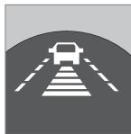
El conductor puede seleccionar diferentes intervalos de tiempo que se indican en la pantalla en forma de 1 a 5 rayas horizontales. Cuanto más rayas, mayor es el intervalo de tiempo. Una raya equivale a una distancia de seguridad de aproximadamente 1 segundo, 5 rayas a aproximadamente 2,5 segundos.
