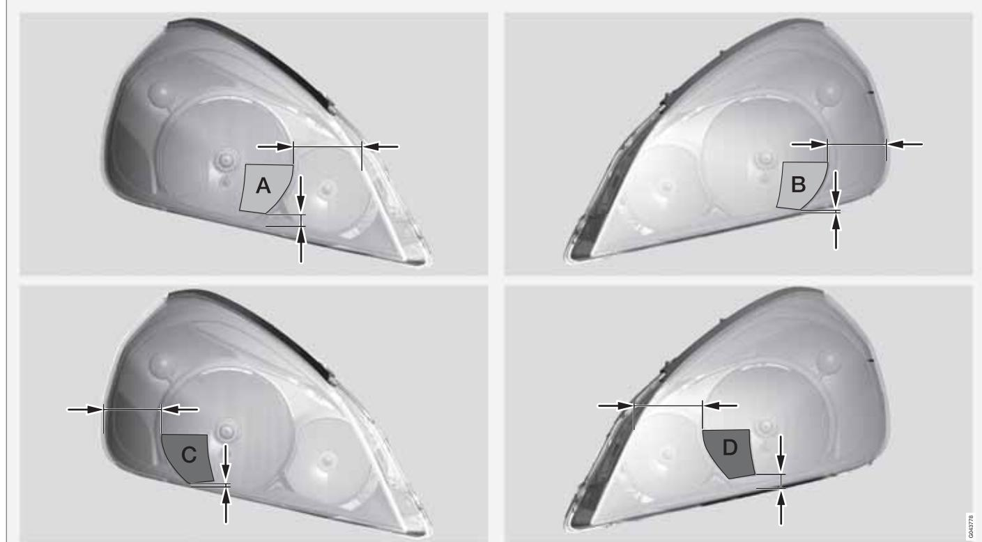
Línea superior: cinta de enmascarar en automóvil con volante a la izquierda, plantillas A y B. Cinta de enmascarar en automóvil con volante a la derecha, plantillas C y D.
