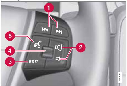
**1** Con una **pulsación breve** se pasa de una pista del disco a otra o de una emisora de radio almacenada a otra<sup>2</sup>. Con **pulsaciones largas** se bobinan las pistas del disco.
