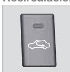
Cuando está conectada la recirculación, se enciende la luz de color naranja del botón. La función se selecciona para impedir la entrada de aire contaminado, gases de escape etc. en el habitáculo.
