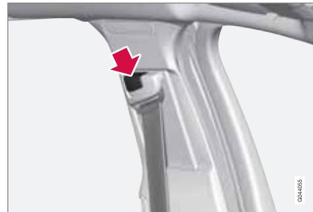
Ajuste en altura de la guía del cinturón de seguridad. Pulse el botón para desplazar la guía en altura. Colocar la guía tan alta como sea posible sin que el cinturón roce con el cuello.
