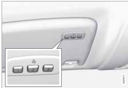
HomeLink® es un mando a distancia programable que puede controlar hasta tres dispositivos diferentes (por ejemplo, la puerta del garaje, el sistema de alarma, la iluminación exterior e interior, etc.) y utilizarse por tanto en lugar de los mandos a distancia correspondientes. HomeLink® se suministra integrado en la visera izquierda.
