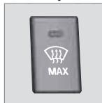
Se utiliza para eliminar rápidamente el vaho y el hielo del parabrisas y las ventanillas laterales. El aire se envía hacia las ventanillas. Cuando la función está conectada, se enciende la luz del botón del desempañador.
