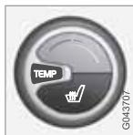
Con una pulsación del botón se obtiene el nivel de calefacción máximo. En la pantalla de la consola central se encienden tres luces de color naranja (véase la figura).
