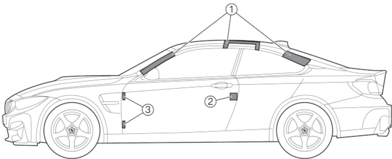
1. Las superficies identifican las zonas en las que se puede separar el techo. Las condiciones previas para cortar la carrocería son tijeras modernas de alto rendimiento. Los aparatos de corte hidráulicos antiguos pueden no resultar útiles.
