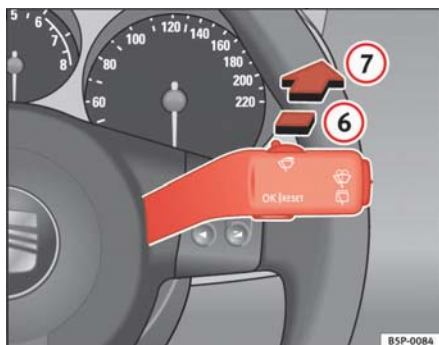
Fig. 86 Palanca del limpia-lavacristales: limpiacristales
