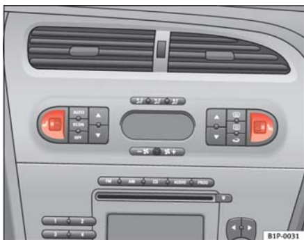
Fig. 93 Ruedecillas moleteadas de la calefacción de los asientos delanteros
