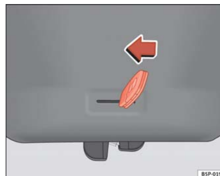
Fig. 69 Portón trasero: apertura de emergencia
