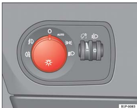
Fig. 75 Encendido automático de luces
