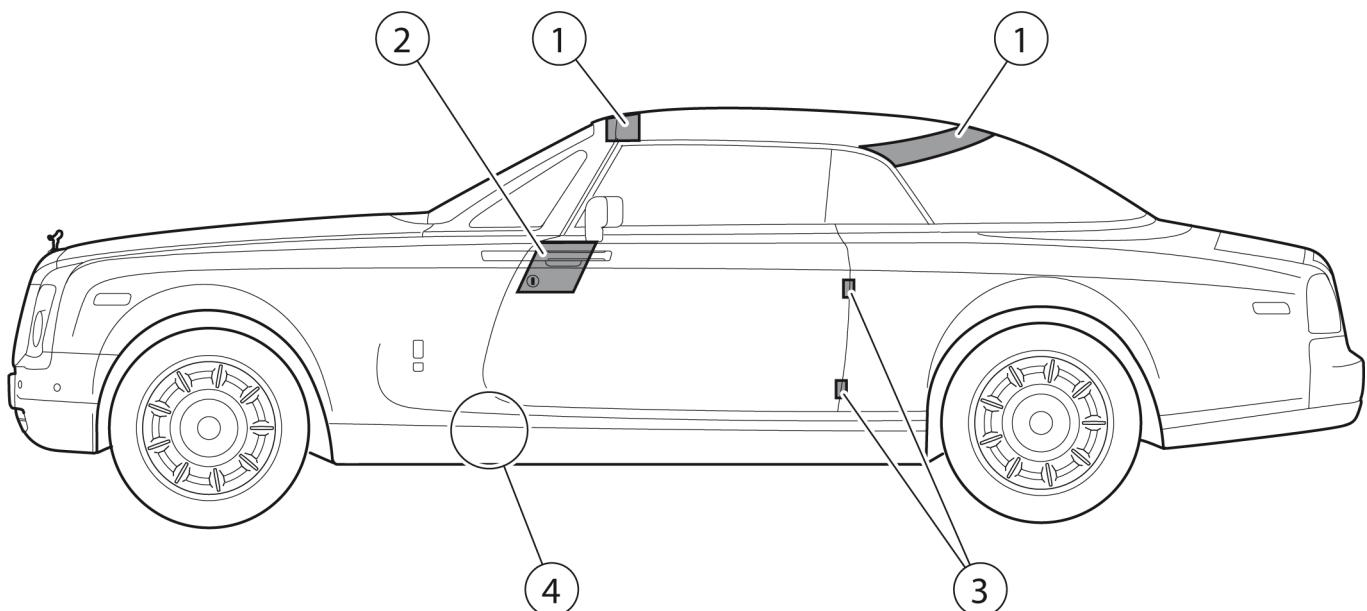
1. Las superficies identifican las zonas en las que se puede separar el techo. Las condiciones previas para cortar la carrocería son tijeras modernas de alto rendimiento. Los aparatos de corte hidráulicos antiguos pueden no resultar útiles.
