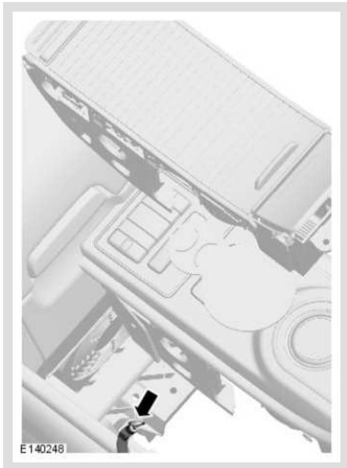
El cable de desactivación de emergencia permite liberar mecánicamente el freno de estacionamiento si:
