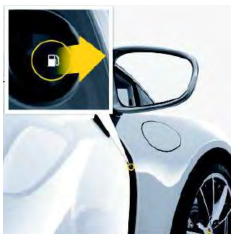
Apertura de emergencia de la tapa de combustible
