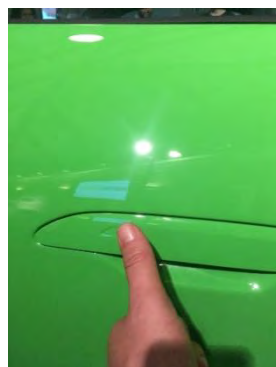
Apertura de emergencia de la tapa de combustible
