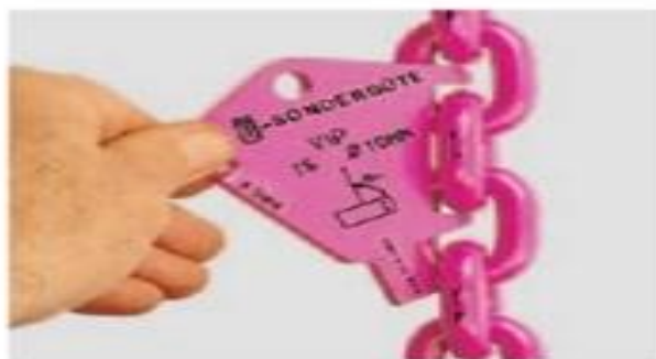
Comprobación del alargamiento plástico del eslabón por sobrecarga.
