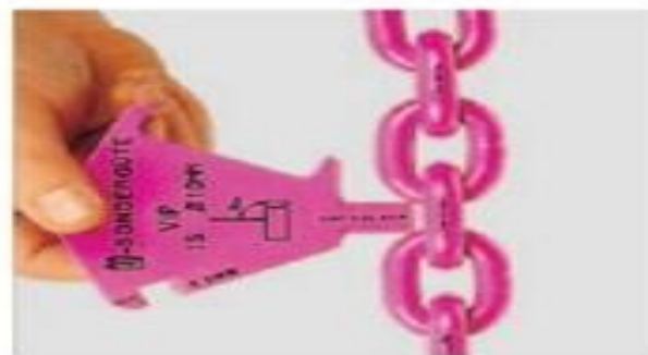
Comprobación del alargamiento del paso del eslabón por desgaste del diámetro nominal.
