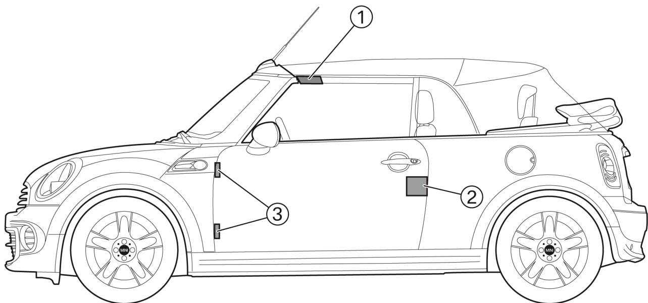
1. Las superficies identifican las zonas en las que se puede separar el techo. Las condiciones previas para cortar la carrocería son tijeras modernas de alto rendimiento. Los aparatos de corte hidráulicos antiguos pueden no resultar útiles.
