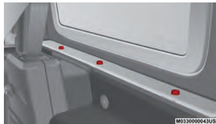
Ubicaciones del tornillo de cabeza Torx — Se muestra el lado derecho
