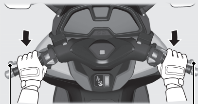
Maneta del freno trasero Maneta del freno delantero
