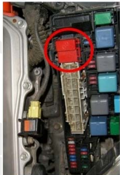
Tomas adicionales de corriente del Toyota Prius situada en la caja de fusibles del motor
