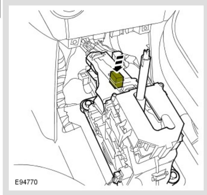
Bloquee el dispositivo de ajuste del cable del selector.
