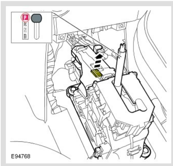
Desbloquee el dispositivo de ajuste del cable del selector.
