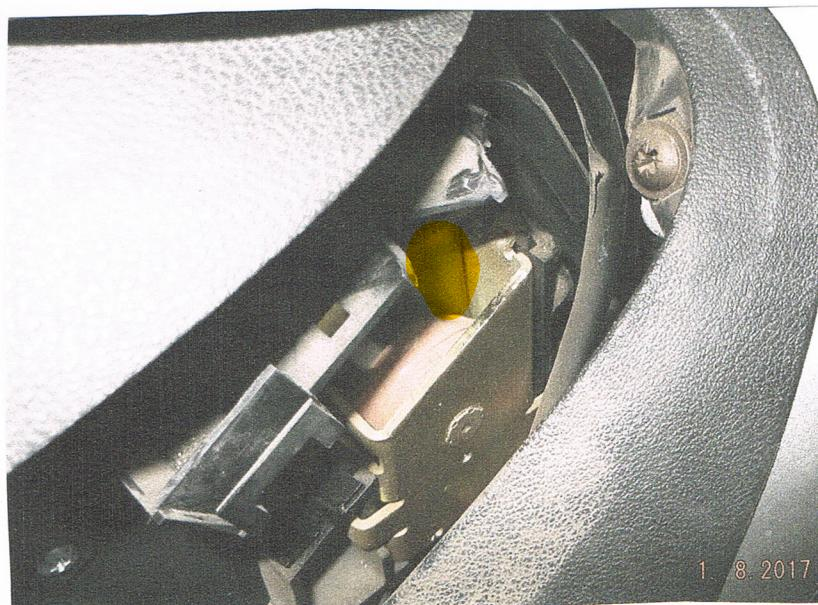
PARA DESBLOQUEAR EL CAMBIO HAY QUE DESPLAZAR ESTA PIEZA HACIA EL LADO DERECHO. ACTUA COMO UN ELECTROIMAN. CUANDO PONEMOS EL CONTACTO LA PIEZA SE DESPLAZA Y HACE TOPE CON ESTA OTRA.
