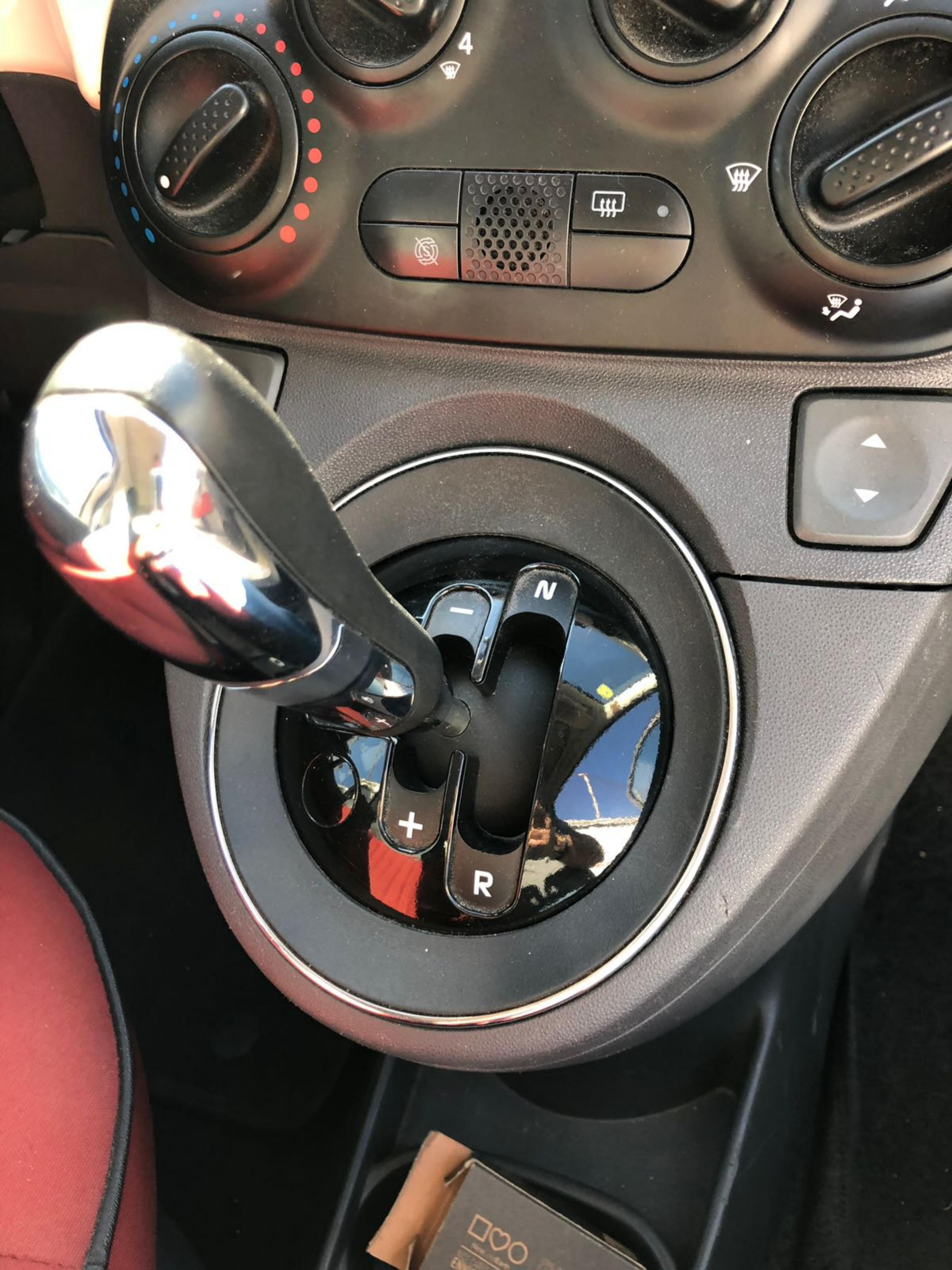
Fiat 500 Semiautomático o Caja Asistida Electrónicamente, el cambio es igual que una caja manual solo que el adcionamiento es electrico, no se puede desbloquear con facilidad, se bloquea con marcha atrás pero no es parking como las cajas automáticas, se puede arrastrar seria como si le diéramos un empujón con una marcha puesta, si contaramos con uno poco de tiempo se le pueden quitar las bujías y el motor al no tener compresión gira con facilidad.
