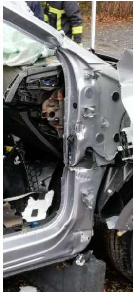
2/ Bereich mit Strukturverstärkung
