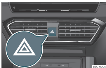
Fig. 96 Tablero de instrumentos: conmutador de los intermitentes de emergencia.
