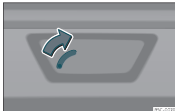
Fig. 90 Detalle del maletero: desbloqueo de emergencia (Leon Sportstourer).
