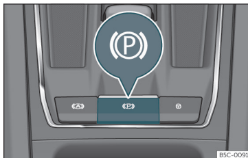
Fig. 186 En la parte inferior de la consola central: tecla del freno de estacionamiento electrónico.
