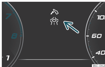
Fig. 59 Indicación de la asistencia para una conducción ecoeficiente (representación esquemática).
