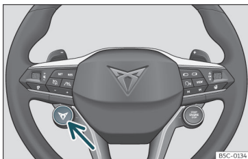
Fig. 158 Volante multifunción*: botón para cambiar el perfil de conducción.
