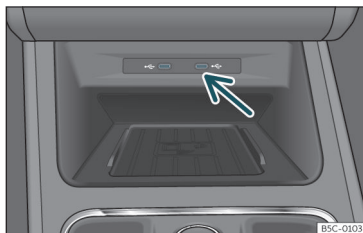
Fig. 151 Consola central: entrada USB.
