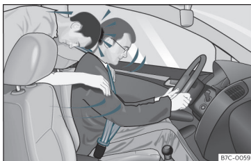
Fig. 12 El ocupante del asiento trasero que no lleve puesto el cinturón de seguridad se verá lanzado hacia adelante sobre el conductor que sí lleva el cinturón.
