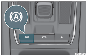
Fig. 187 En la parte inferior de la consola central: tecla de la función Auto Hold.
