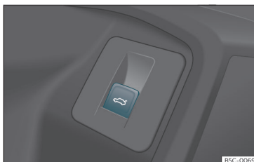
Fig. 87 En la puerta del conductor: tecla para abrir y cerrar el portón trasero.
