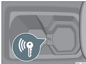
Fig. 154 En la consola central: arranque de emergencia.
