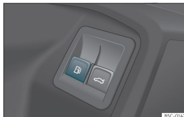
Fig. 209 Puerta del conductor: desbloqueo de la tapa del depósito.
