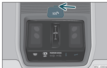
Fig. 36 En la consola del techo: mandos para los servicios de voz
