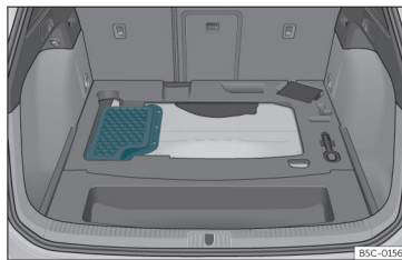
Fig. 222 Ubicación de la batería en el maletero
