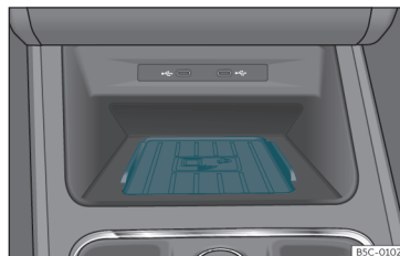
Fig. 150 En la consola central: alojamiento para la conexión del teléfono móvil.
