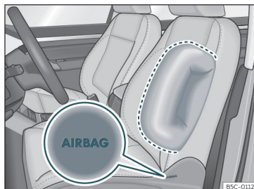
Fig. 25 Airbag lateral en el asiento del conductor.
