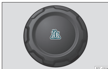
Fig. 218 Vano motor: tapón del depósito de expansión del líquido refrigerante.
