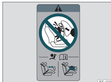
Fig. 30 Adhesivo del airbag: en el marco posterior de la puerta del acompañante
