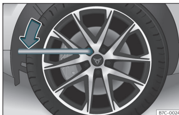
Fig. 41 Cambio de rueda: aflojar los tornillos de rueda.
