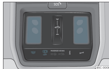
Fig. 97 Detalle del revestimiento del techo: iluminación delantera del habitáculo.
