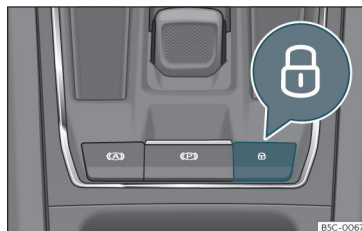
Fig. 79 En consola central: conmutador del cierre centralizado
