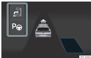
Fig. 189 En la pantalla del cuadro de instrumentos: visualización del sistema de aparcamiento asistido con visualización reducida.
