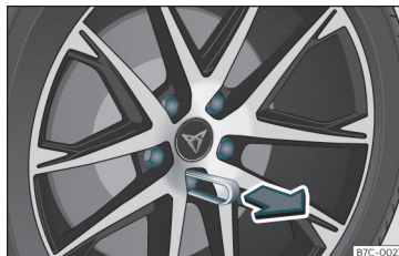
Fig. 39 Rueda: tornillos de la rueda con capuchones.
