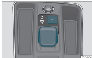
Fig. 156 En la consola central: mando selector.
