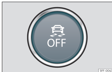
Fig. 188 En la parte inferior de la consola central: botón para conectar/desconectar el ESC
