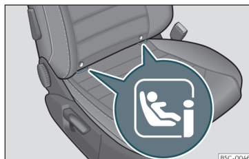
Fig. 32 Asiento pasajero delantero: anillas de sujeción ISOFIX/i-Size.
