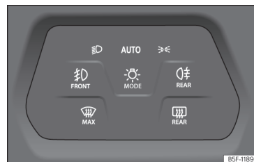
Fig. 94 Tablero de instrumentos: mando de las luces.
