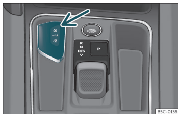
Fig. 74 Consola central: alojamiento para la llave del vehículo.
