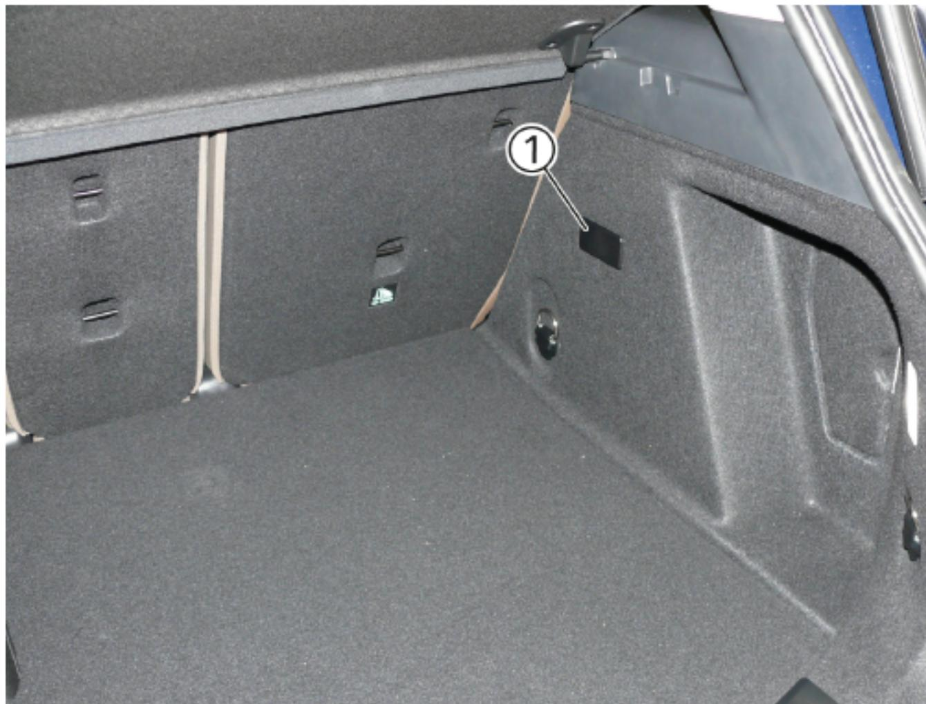
Presionar el cortacircuito seccionador del conector (1) hacia abajo y extraerlo. Desenchufad el conector del punto de separación de alto voltaje (2) (Service Disconnect) en la dirección de la flecha.
