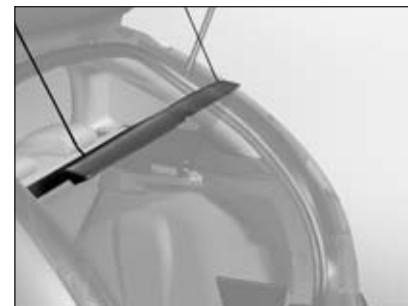
Desmontaje (modelo 5 puertas) - Descolgar los cordones. - Levantar ligeramente y tirar.
