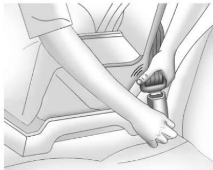
4. Empuje la placa de cerrojo dentro del broche hasta que escuche un sonido de clic. Coloque el botón de liberación sobre el broche de tal forma que el cinturón de seguridad se desabroche rápidamente si es necesario.
