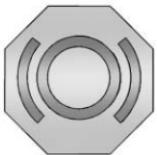
El tapón del depósito del líquido de frenos/embrague hidráulico tiene este símbolo. Vea en *Vista general del compartimiento del motor* ▷ 277 la ubicación del depósito.
