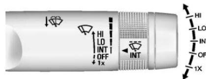
La palanca del limpiador/lavador del parabrisas está en el lado derecho de la columna de dirección. Estando la ignición en ACC/ACCESSORY (acc/accesorio) o en ON/RUN (encendido/funcionamiento), mueva la palanca de la escobilla del parabrisas para seleccionar la velocidad de movimiento de la escobilla.
