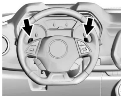
El Cambio manual le permite controlar manualmente la transmisión automática. Para usar el Cambio manual, la palanca de cambios debe estar en Modo DSC. Los vehículos con esta función tienen indicadores en el volante. Las paletas se encuentran en la parte trasera del volante. Toque la paleta izquierda (-) para cambiar a una velocidad menor y la paleta
