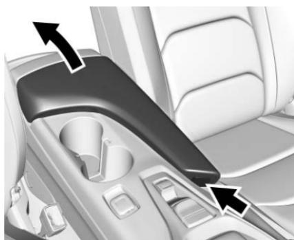
Presione para abrir. Si está equipado, hay un puerto USB y un conector auxiliar en su interior. Vea *Puerto USB* ▷ 179, *Dispositivos auxiliares* ▷ 180, y el manual de infoentretenimiento.
