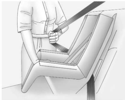
4. Jale el cinturón de hombro completamente fuera del retractor para ajustar el seguro. Cuando el seguro del retractor esté ajustado, el cinturón se puede apretar pero no se puede jalar fuera del retractor.
