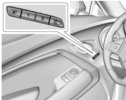
Si está equipado, se utilizan los botones 1, 2 SET, y (Salir) en la puerta de conductor para almacenar y recuperar manualmente las configuraciones de memoria para el asiento del conductor y los espejos exteriores.
