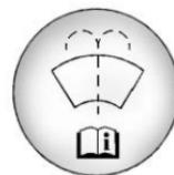
Abra el tapón que tiene el símbolo del lavaparabrisas. Añada líquido de lavado hasta llenar el depósito. Vea en *Vista general del compartimiento del motor* ▷ 277 la ubicación del depósito.
