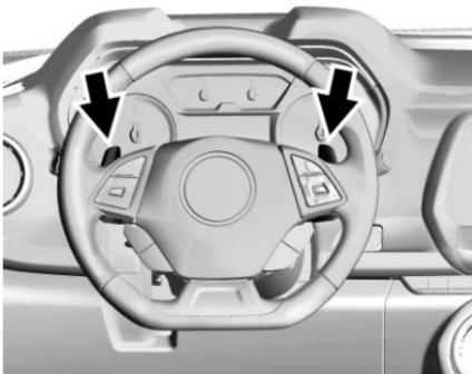
El sistema se activa y desactiva presionando cualquiera de las paletas marcadas REV MATCH en el volante. El sistema debe activarse en cada nuevo ciclo de ignición.
