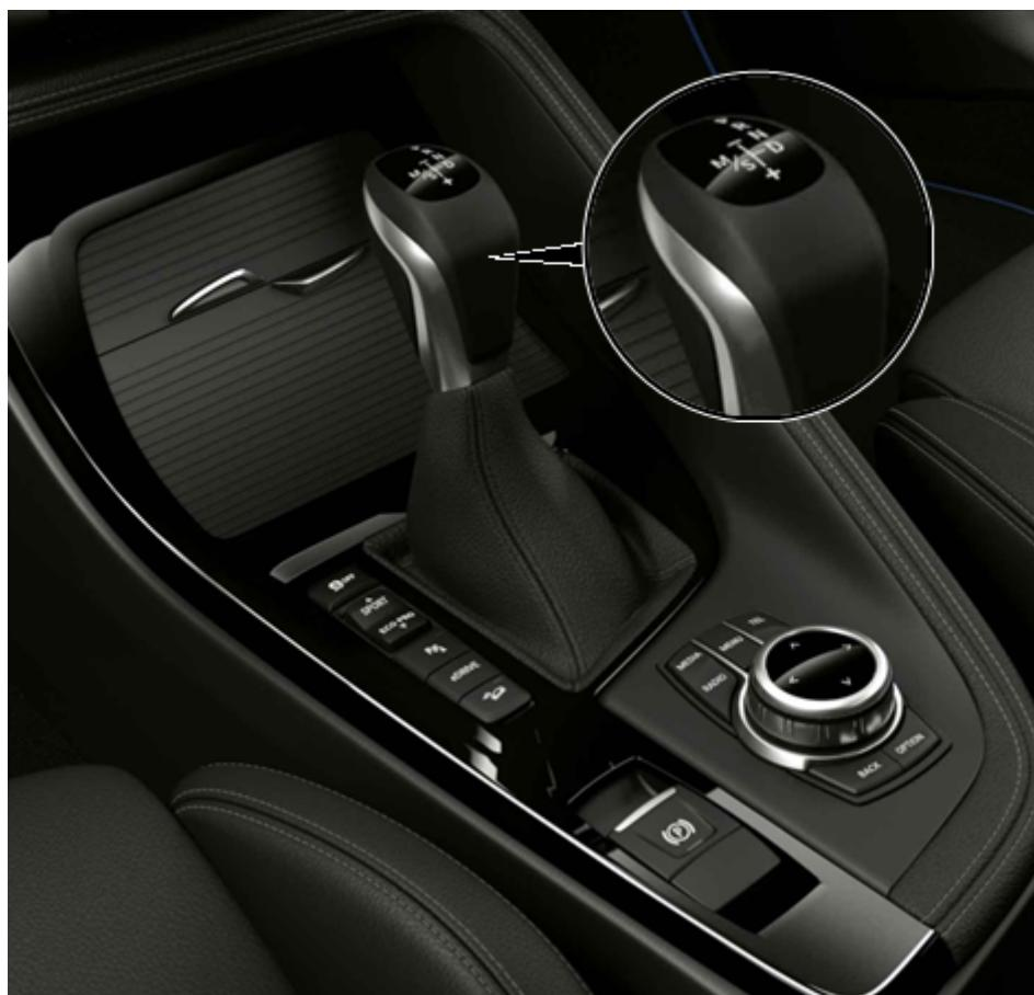
Pulsar el conmutador del freno de estacionamiento eléctrico hacia arriba.
