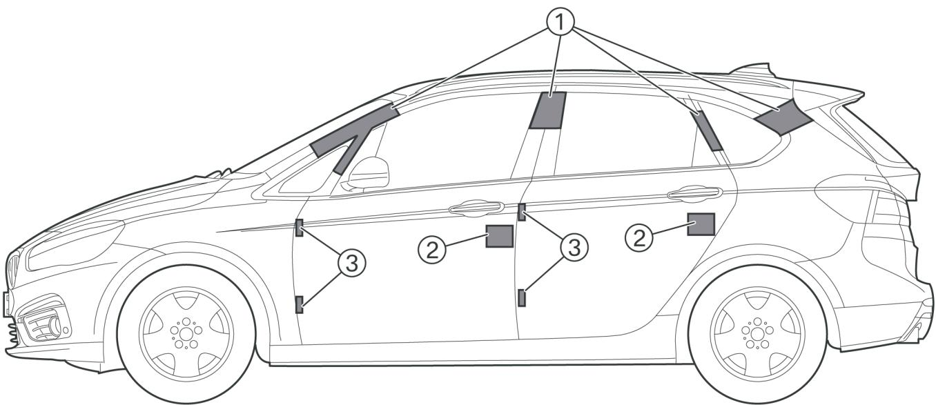
1. Las superficies identifican las zonas en las que se puede separar el techo. Las condiciones previas para cortar la carrocería son tijeras modernas de alto rendimiento. Los aparatos de corte hidráulicos antiguos pueden no resultar útiles.
