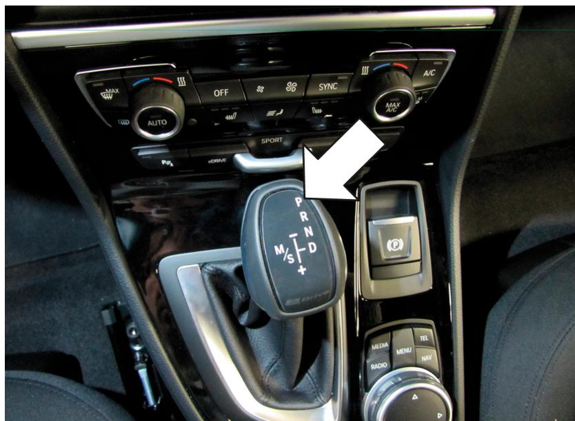
Tirar hacia arriba del commutador del freno de estacionamiento eléctrico.
