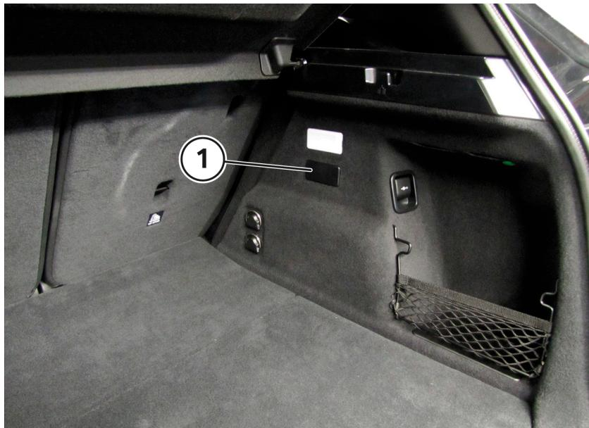
Presionar hacia abajo y extraer el fusible de desconexión del conector (1). Desacoplar el conector para el punto de separación de alto voltaje (2) desplazándolo en la dirección de la flecha.
