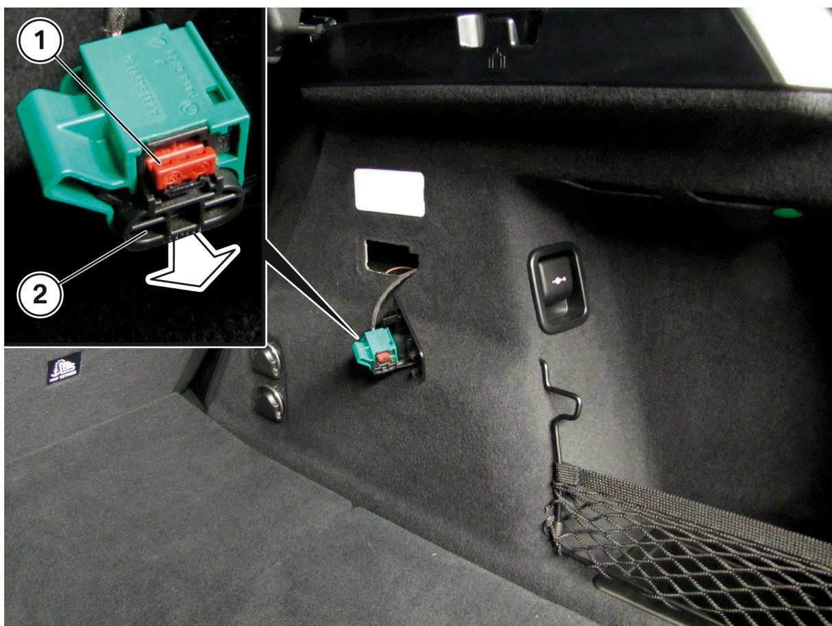
El sistema de alto voltaje estará desactivado cuando el orificio (1) esté completamente libre.
