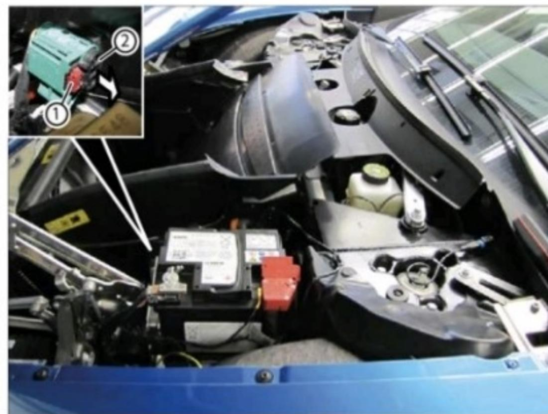
El sistema de alto voltaje está desactivado cuando el orificio (1) está completamente libre.
