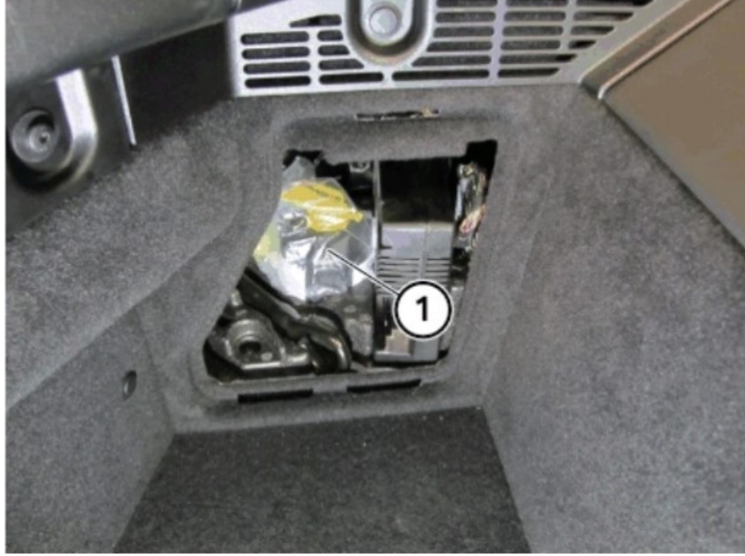
Cortad el cable (1) del punto de separación de alto voltaje (solución de corte). El sistema de alto voltaje está desactivado.
