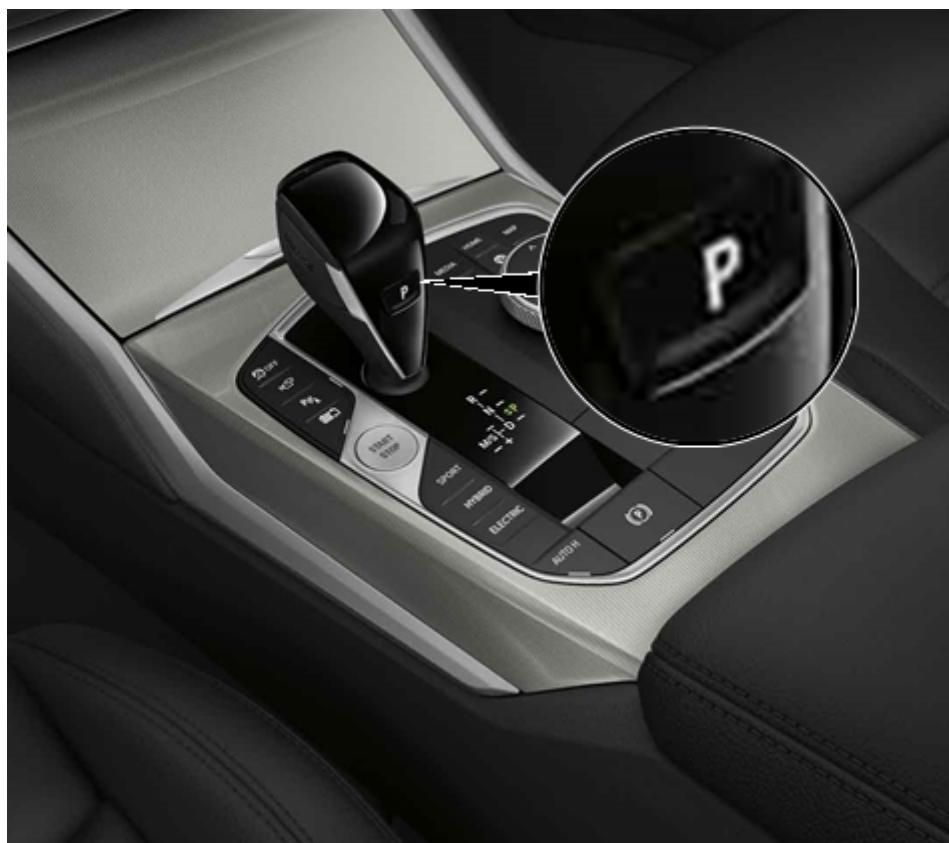
Pulsar el conmutador del freno de estacionamiento eléctrico hacia arriba.
