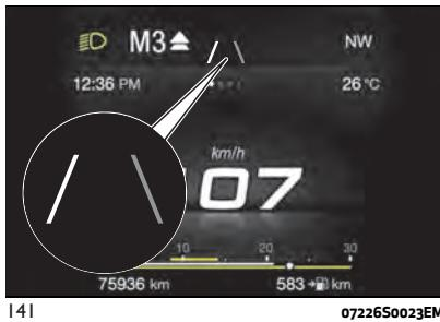
Cuando el sistema detecta que el vehículo se ha acercado a la línea del carril y está a punto de superarla, en la pantalla del cuadro de instrumentos la línea izquierda se ilumina en color amarillo y rojo fig. 142.
