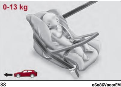
El asiento está limitado por el cinturón de seguridad del vehículo, como se indica en fig. 88 y debe a su vez a frenar al niño con sus cinturones incorporados.
