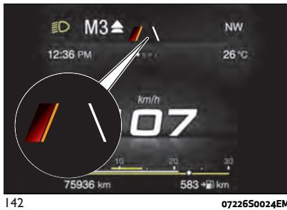
El sistema funciona de la misma manera pero de forma especular en caso de cambio de carril a la derecha, cuando se detecta sólo el límite derecho del carril.
