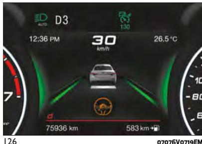
Transcurridos unos segundos sin que el conductor coloque las manos sobre el volante, la pantalla del cuadro de instrumentos muestra la siguiente vista fig. 127.
