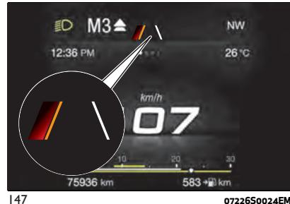
El sistema funciona de la misma manera pero de forma especular en caso de cambio de carril a la derecha, cuando se detecta sólo el límite derecho del carril.
