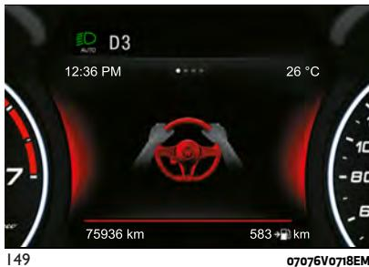
si el conductor no coloca las manos sobre el volante antes de que se cumpla el tiempo máximo admitido, el sistema LKA se desactiva y en la pantalla del cuadro de instrumentos se visualiza un mensaje específico. En este caso, se emite una señal acústica prolongada. En los últimos tres casos indicados anteriormente, es necesario volver a colocar las manos en el volante.
