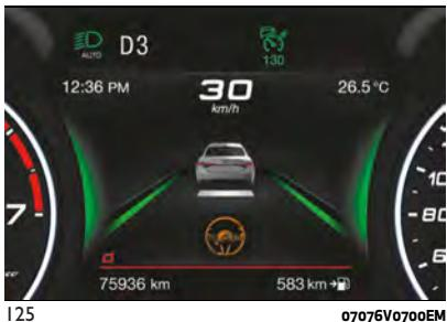
Al retirar las manos del volante, el sistema no se desactiva automáticamente sino que deben transcurrir unos segundos. En la pantalla del cuadro de instrumentos se visualizan, en secuencia, una serie de vistas específicas para avisar al conductor que debe colocar las manos sobre el volante (ver lo descrito a continuación).
