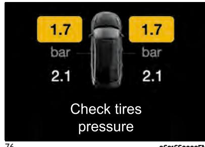
La presión de inflado varía en base a la temperatura de aproximadamente 0.07 bar cada 6.5°C. Esto significa que al disminuir la temperatura externa disminuye la presión de los neumáticos. Ajustar siempre la presión de inflado de los neumáticos en frío. Esta última está definida como la presión de los neumáticos tras al menos 3 horas de inactividad del vehículo o un recorrido inferior a 1,6 km tras un intervalo de 3 horas.
