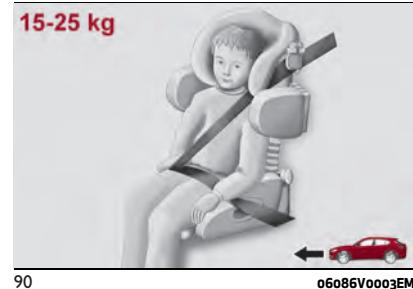
En este caso, las sillas de coche solamente tienen la función de colocar correctamente al niño respecto a los cinturones de seguridad, de modo que el tramo diagonal se adhiera al tórax y no al cuello, y que el tramo horizontal del cinturón de seguridad se adhiera a la pelvis y no al abdomen del niño.
