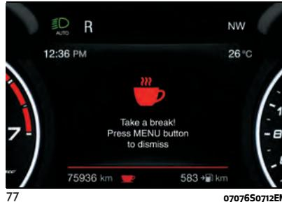
❑ Si el conductor **acepta** la sugerencia del sistema, al pulsar el botón MENÚ de la palanca derecha del volante y detenerse para descansar, el mensaje desaparece de la pantalla y permanece encendido el símbolo ☕ en el área específica de la pantalla del cuadro de instrumentos fig. 78 hasta que se apaga y se vuelve a arrancar el motor.
