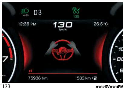
En este caso, se emite una señal acústica. Si el conductor no coloca las manos sobre el volante tras un período de tiempo prolongado, en la pantalla del cuadro de instrumentos
