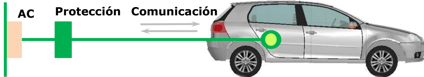
Toma estándar de uso no exclusivo con sistema de protección en cable
