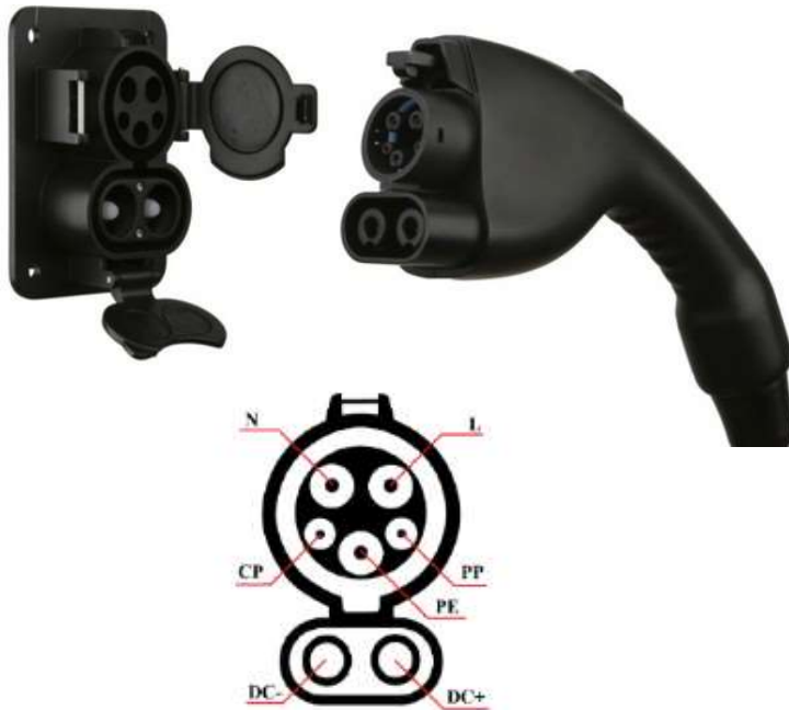
Conector CCS combinado Tipo 1 (EEUU)
